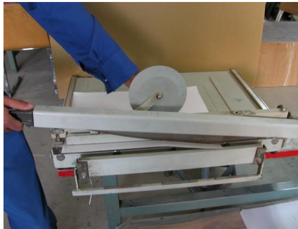
شكل رقم ٧٤: المقص اليدوي المستخدم في قص شرائح الورق
