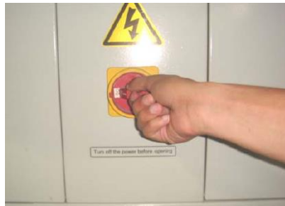
شكل رقم ٥٧: فصل التيار الكهربائي عن الماكينة
