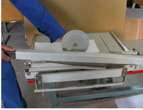
شكل رقم ٧٩: المقص اليدوي المستخدم في قص شرائح الورق
