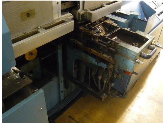
شكل رقم ٤٧: وعاء صهر المواد اللاصقة لماكينات البشر والتغيرية
